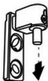
Poser le 1er vantail sur le pivot au sol, insérer le gond dans l'orifice du montant et maintenir le vantail d'aplomb. Tracer l'emplacement des fixations ou le contour du gond
